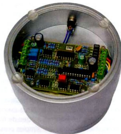
La base du bloc-moteur laisse voir son circuit de régulation PLL
