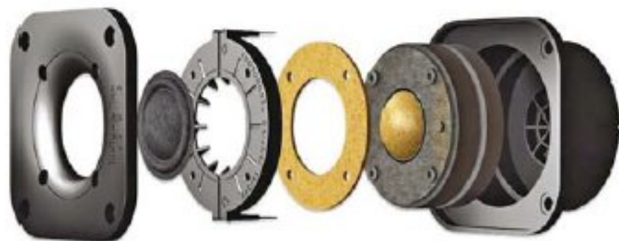
Tweeter della serie Diva by Indiana Line. Il driver è dotato di una camera posteriore nella quale è racchiuso ed un sistema isolante dal mobile che lo sostiene. Entrambe le soluzioni proteggono l'altoparlante da sollecitazioni estranee a quelle atte a produrre suoni propri.
