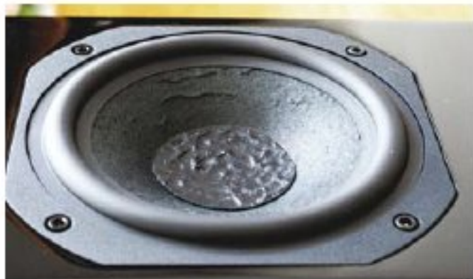
Molto bello il cono in carta del woofer da 140 millimetri delle Diva 552, operante in reflex con condotto anteriore, soluzione che rende meno critica l'interazione acustica con le pareti posteriori.
